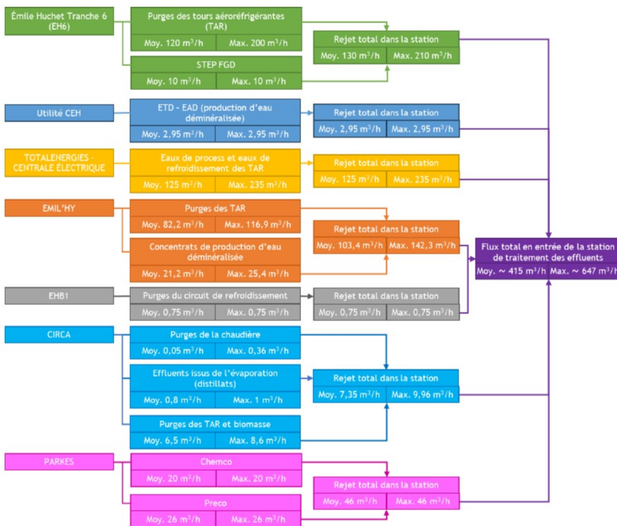
Figure 2: schéma de collecte des effluents en amont de la station d'épuration
