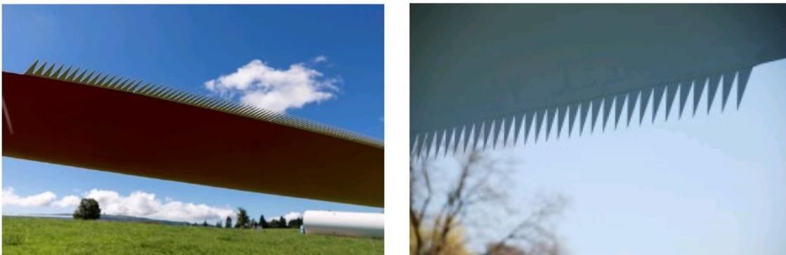
**Figure 15: Exemples de pales munies de dentelures**
