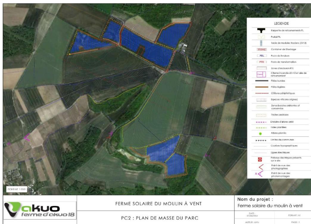
**Figure 2: Plan de masse du parc photovoltaïques**
