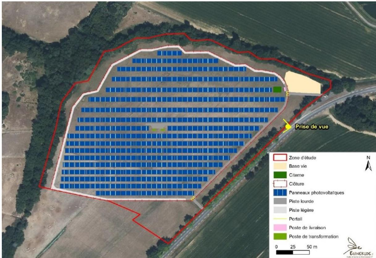
**Figure 2 : photo aérienne des principales composantes du projet (source : géoportail – extrait du PC)**
