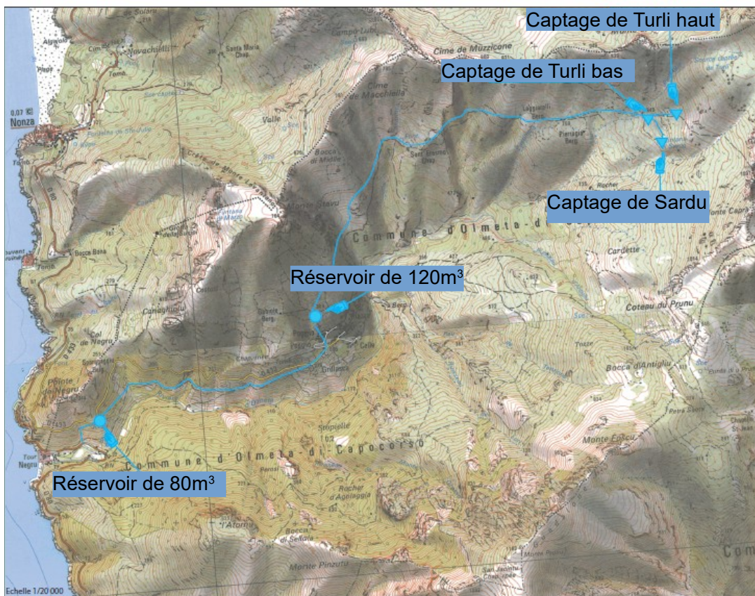
Équipements d'approvisionnement en eau potable (source : rapport de présentation, page 158)
