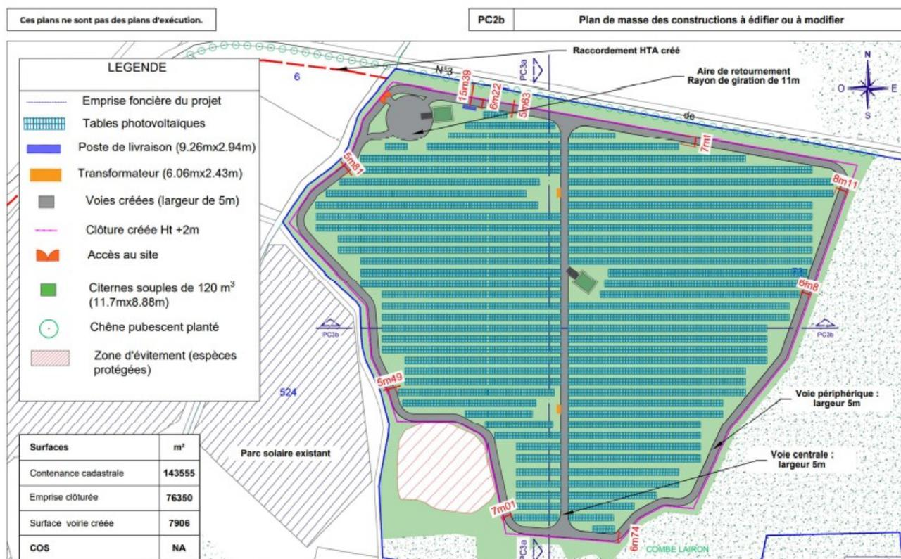
Figure 2: Plan d'implantation du projet (source : permis de construire – pièce PC2b)
