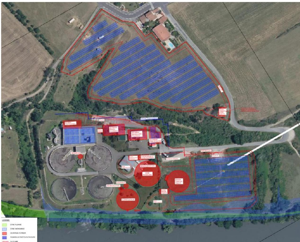
Figure 3: Implantation des ouvrages et installations de traitement futurs de la STEP de Romans-sur-Isère (source RNT)
