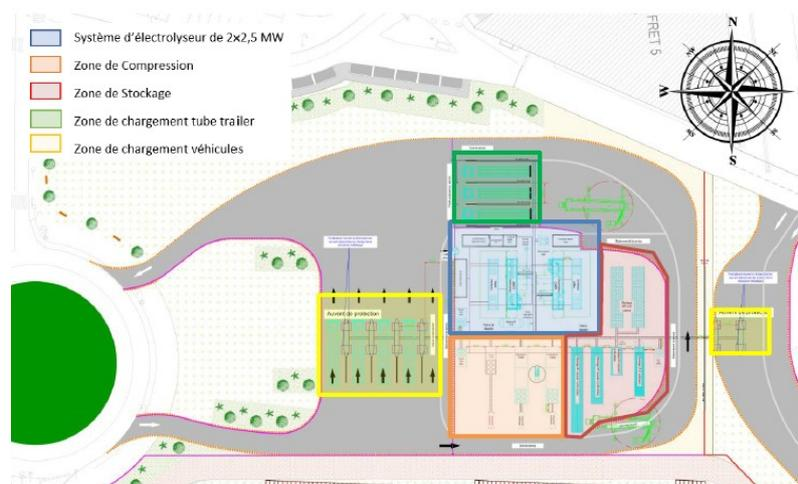
Figure 2 : zone de production, stockage et distribution d'hydrogène (source : étude d'impact)
