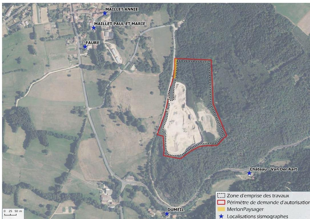
Figure 10: Localisation des sismographes mis en place lors des tirs de mine (source : dossier)
