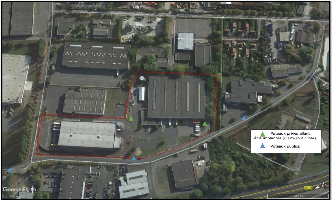
Plan du site avec les bâtiments NS01 à droite et NS02 à gauche (source : dossier de demande d'autorisation environnementale page 306)
