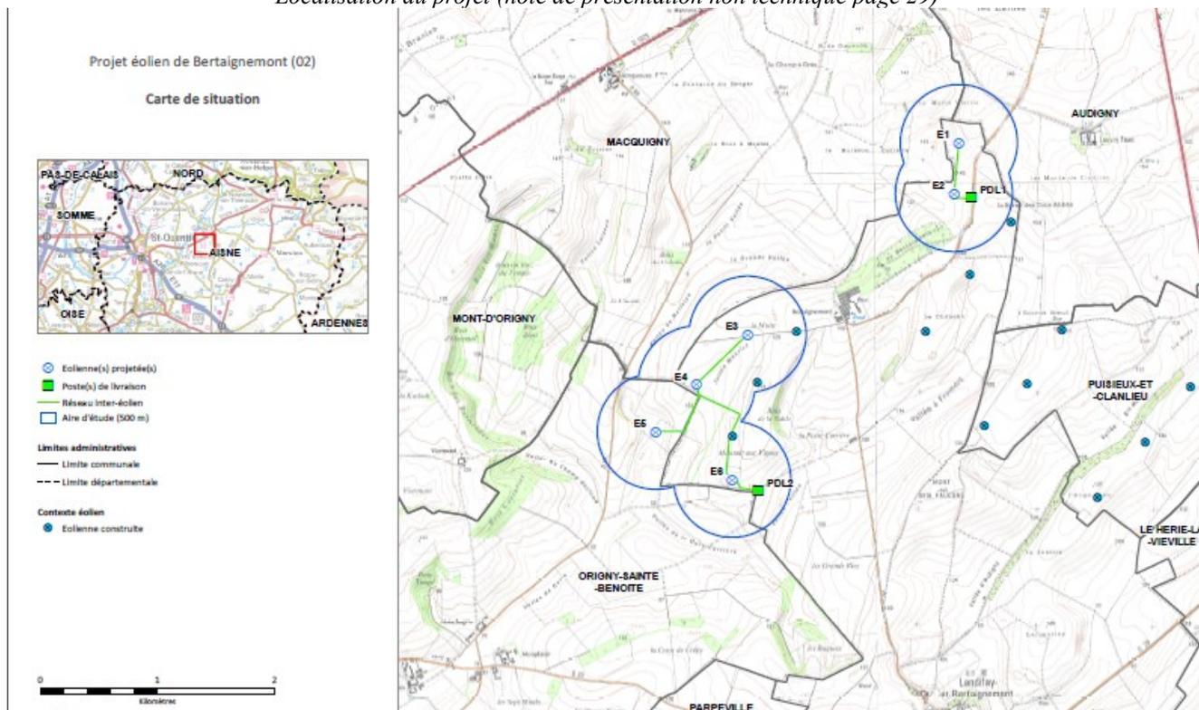
Le parc éolien comprend également la création de deux postes de livraison à proximité des éoliennes E2 et E6, des plateformes de montage, ainsi que la réalisation et le renforcement de pistes d'accès. L'emprise totale du projet sera d'environ deux hectares (surfaces des plateformes, pistes créées et postes de livraison) : cf. étude d'impact pages 61 et 62.
