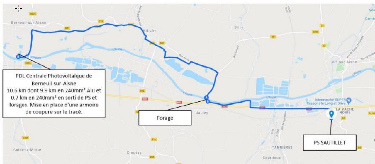
raccordement prévisionnel proposé par ENEDIS/RTE (étude d'impact, figure 7 page 56)
