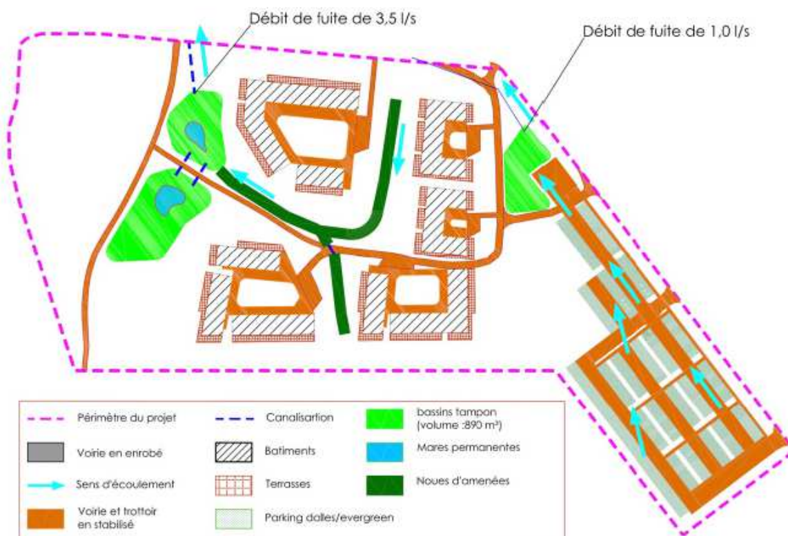
Synoptique hydraulique des eaux pluviales (dossier pétitionnaire : annexe 1 - CHA PC4 notice architecturale A4 ind1 page 42)
