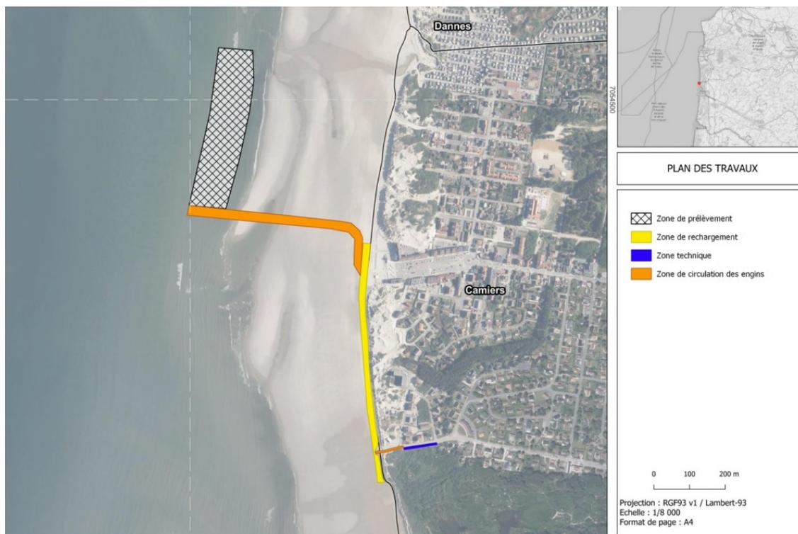
*Schéma de principe des travaux (page 22)*
