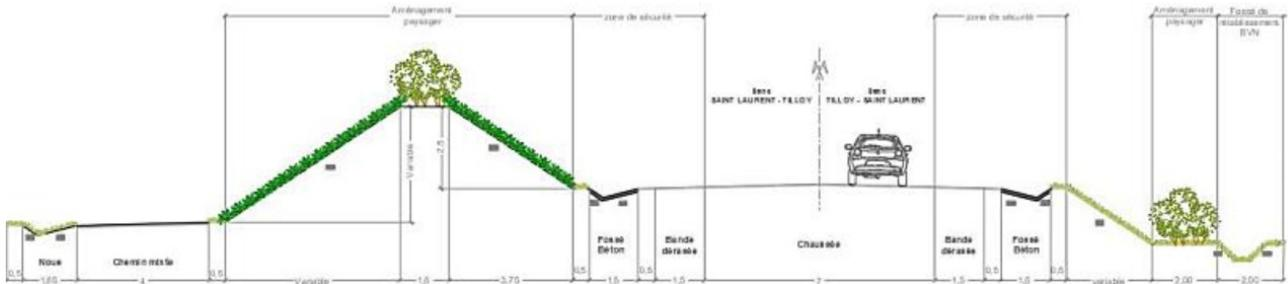
*Profil en travers de la section courante en remblai et avec merlon acoustique
