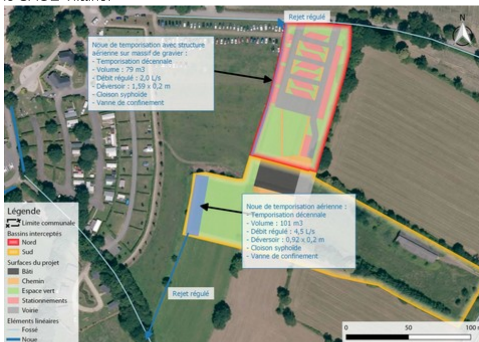
Traitement des eaux pluviales (Étude d'impact)
