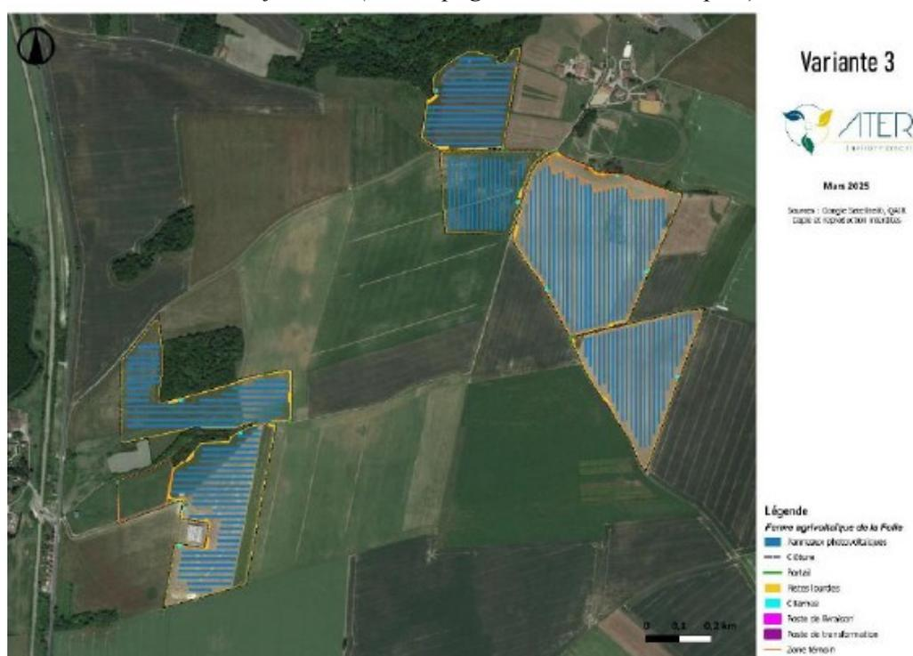
Le projet consiste à implanter un ensemble de 918 tables de panneaux photovoltaïques, soit 303 structures fixes comprenant chacune 84 modules, et 615 structures mobiles comprenant chacune 54 modules (page 238 de l'étude d'impact). Le projet prévoit deux types de structures : des tables fixes sur les prairies et des trackers<sup>4</sup> sur les terres arables.
