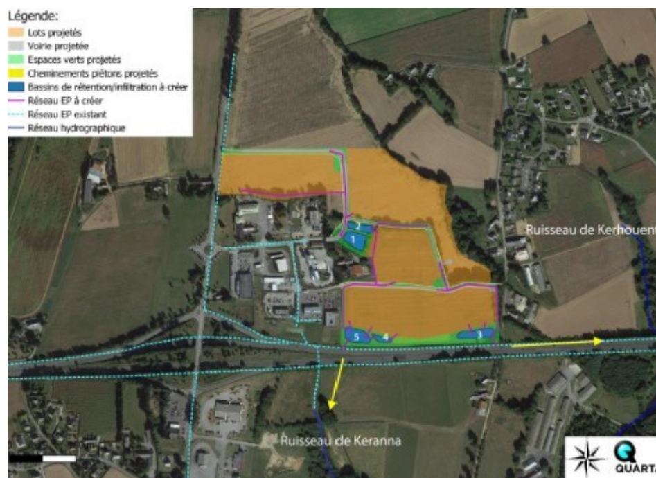
Illustration 6: Principe de gestion des eaux pluviales du projet d'extension
