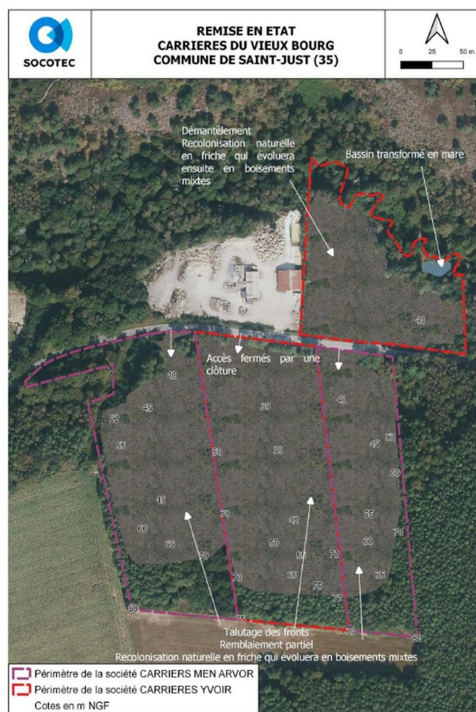
Principes de remise en état (source : études d'impact)
