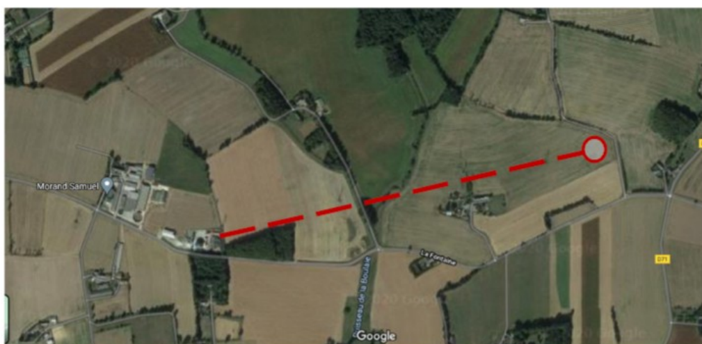
Tracé de la canalisation de transfert des effluents enterrée depuis le site de méthanisation jusqu'à la fosse de stockage déportée au lieu-dit Caille Thébault (extrait du dossier)
