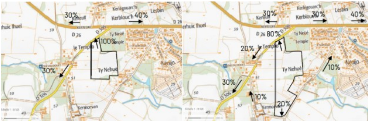
Illustration 7: Répartition des flux à l'issue de l'aménagement des tranche 1 et 2 (à gauche) et à l'issue de l'aménagement global (à droite)
