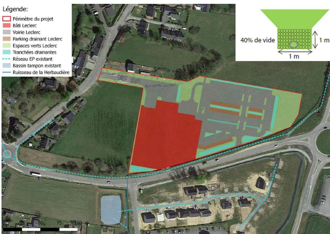
Illustration 6: localisation des ouvrages de gestion des eaux pluviales prévus, et profil d'une tranchée drainante (source : dossier p.189 et annexe 2 p.326 pour le profil de tranchée)
