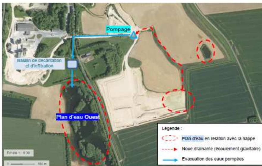
Figure 4: Condition d'écoulement des eaux sur la carrière autorisée (source : p. 27 de l'annexe 2)
