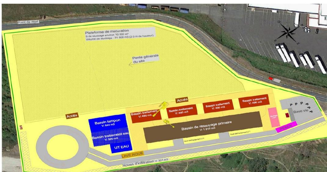
Plan de principe de la plate-forme de tri-transit et traitement des sédiments (source : description du projet, p. 19)
