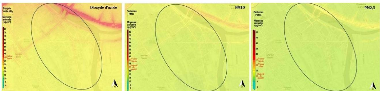
**Illustration 23 : Concentration en NO<sub>2</sub>, PM<sub>10</sub> et PM<sub>2,5</sub> dans le secteur projet à l'état initial. La cartographie montre des dépassements aux abords de certaines voies de circulation au sein de la Zac et notamment sur les rues Westermeyer (RD 154A) et Lénine (RD 154B) en prolongement des ponts Nelson Mandela (étude d'impact, p. 181, source : AirParif).**
