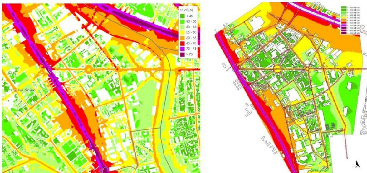
Illustration 19 : Niveaux de bruit global pour la période nocturne 22 h-6 h (Ln). À gauche : Bruitparif (transports, 2022), à droite la modélisation, la légende est identique à celle de BruitParif, en dehors du fait que trois tons prune difficilement différenciables indiquent >75 dB(A) et deux tons de vert foncé difficilement différenciables indiquent < 45 dB (A) (BruitParif et p. 271).
