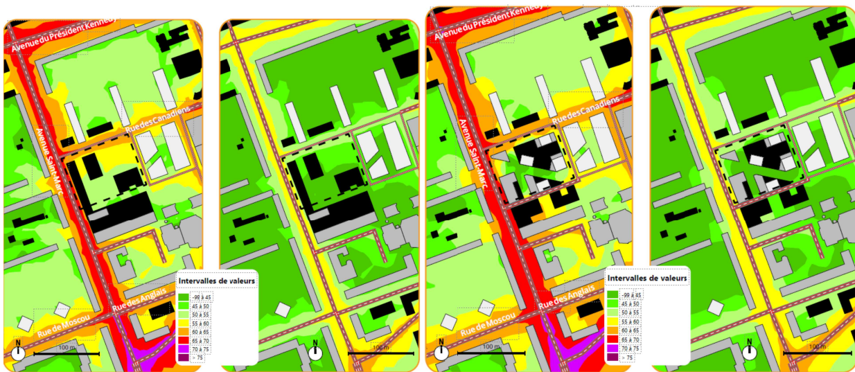
Figure 3: État initial, niveaux mesurés à quatre mètres du sol (EI p. 251) - en orange 60 à 65 dB, rouge 65 à 70, mauve 70 à 75 dB. Le périmètre du projet est marqué en pointillés noirs. Figure 4: État avec projet (à quatre mètres du sol) (EI p. 253)
