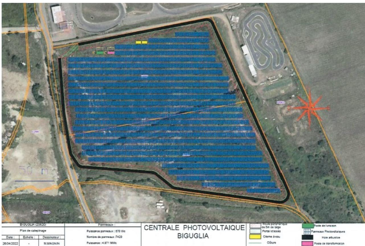
Figure 2. Plan de masse du projet de parc photovoltaïque de Biguglia « Suariccia »
