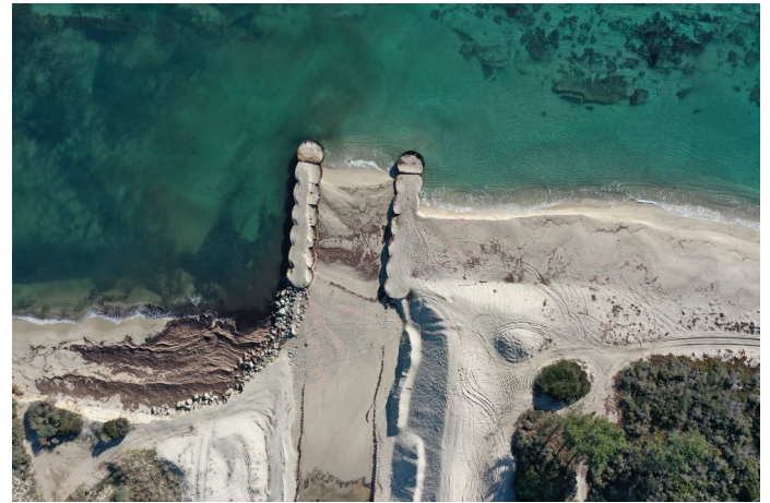
Vue de la bordigue à gauche, du chenal au niveau des musoirs à droite (avec l'accumulation des sédiments)
