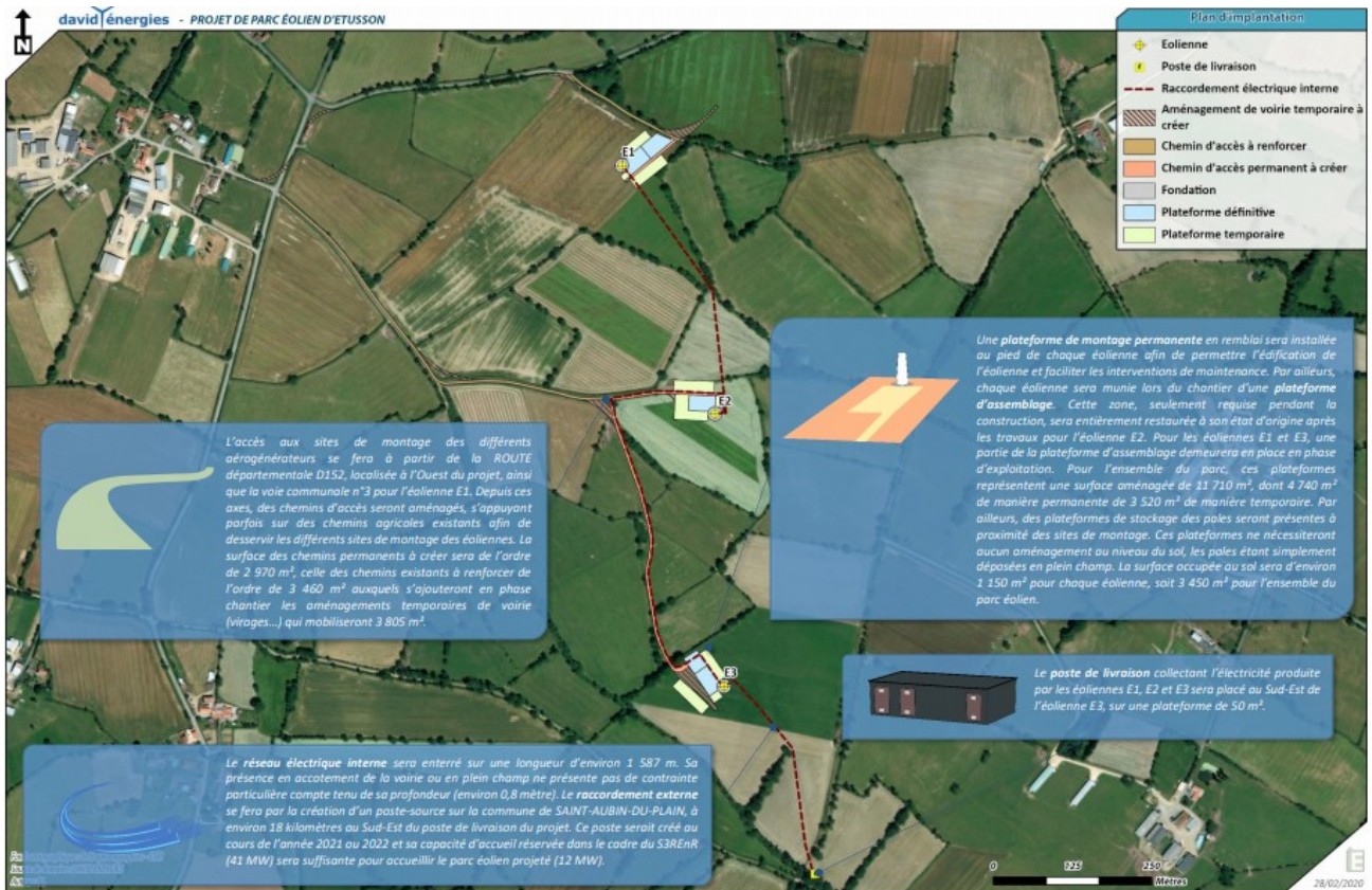
Figure 10 : Description de l'installation projetée
