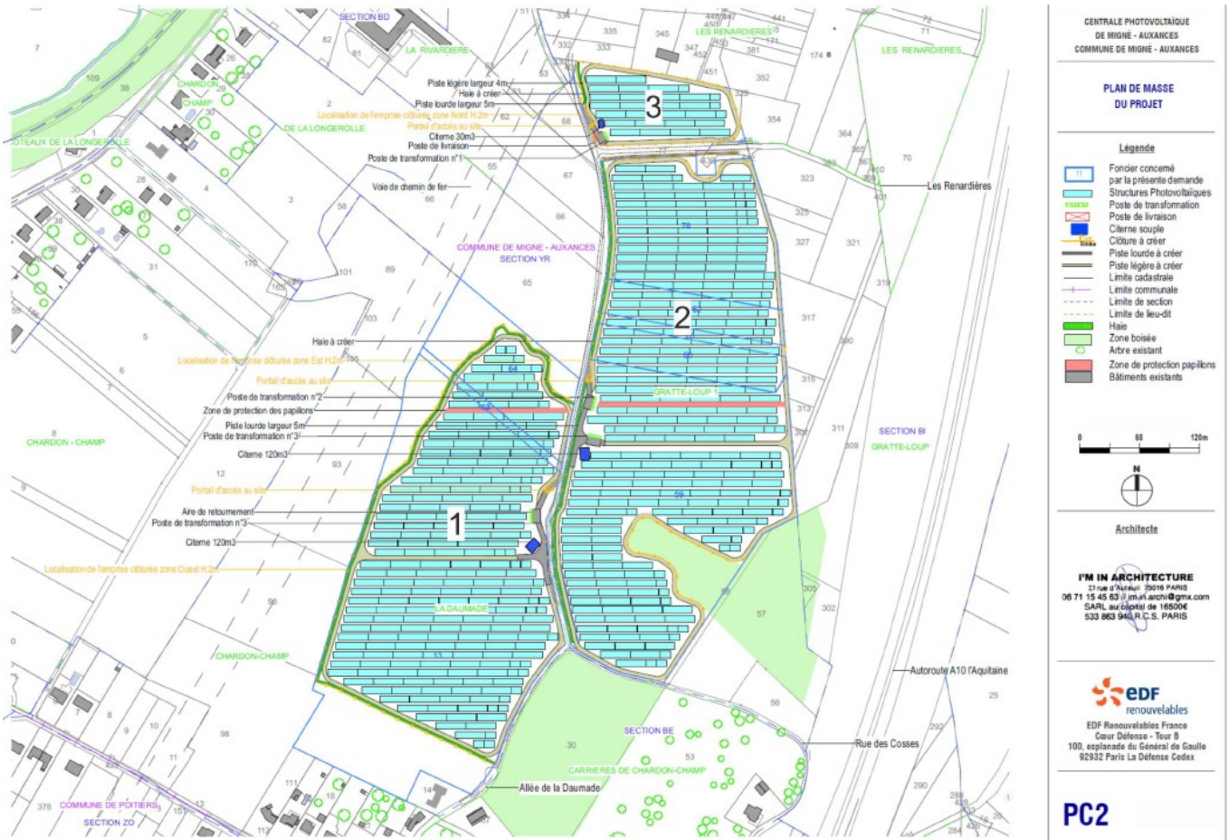
Figure 10 : Plan du projet de centrale photovoltaïque de Migné-Auxances (source : EDF RENEUVELABLES)
