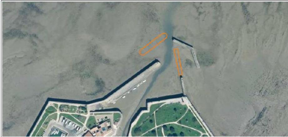
Plan du réaménagement (nouveau brise-lame et brise-clapot en orange, l'épi en V est voué à la déconstruction)
