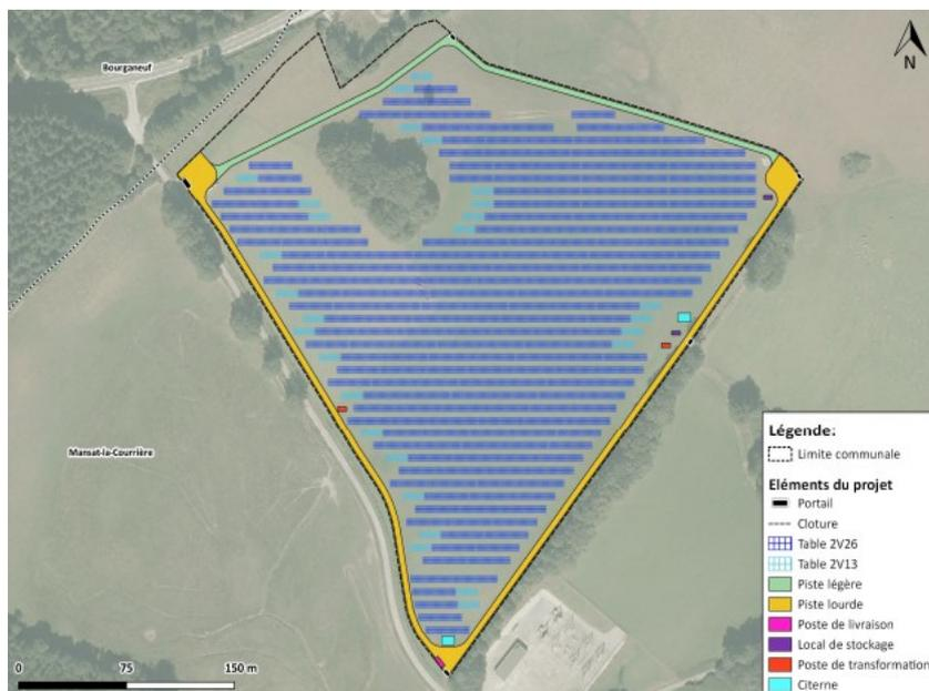
Le point bas des structures portant les modules photovoltaïques est prévu à 2,50 m de hauteur, et le point haut à 3,70 m. La centrale solaire comprendra deux postes de transformation, un poste de livraison, des réseaux de câbles<sup>2</sup>, des voies de circulation et deux citernes incendie de 60 m<sup>3</sup> chacune. Son raccordement
