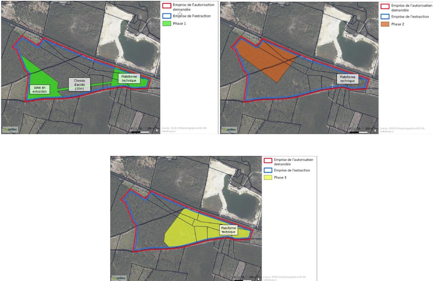
Phase 1 (0 à 5 ans) : défrichage et décapage des secteurs nord-est et sud-ouest de l'emprise. Confection du merlon sur la lisière nord-est et est à l'aide de la découverte. Extraction du sud vers le nord.
