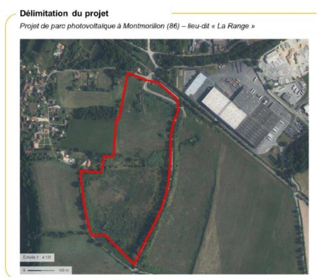
Le projet prévoit, sur une surface clôturée de 5,26, ha, la mise en place de 11 556 modules photovoltaïques à base de silicium cristallin, disposés sur des structures fixes orientées plein sud qui seront ancrées au sol par un système de pieux battus. La surface au sol des panneaux représentera environ 3 ha, soit 57 % de l'emprise clôturée. Le projet comprend également la création d'un poste de livraison au sud-est du site et un poste de transformation.
