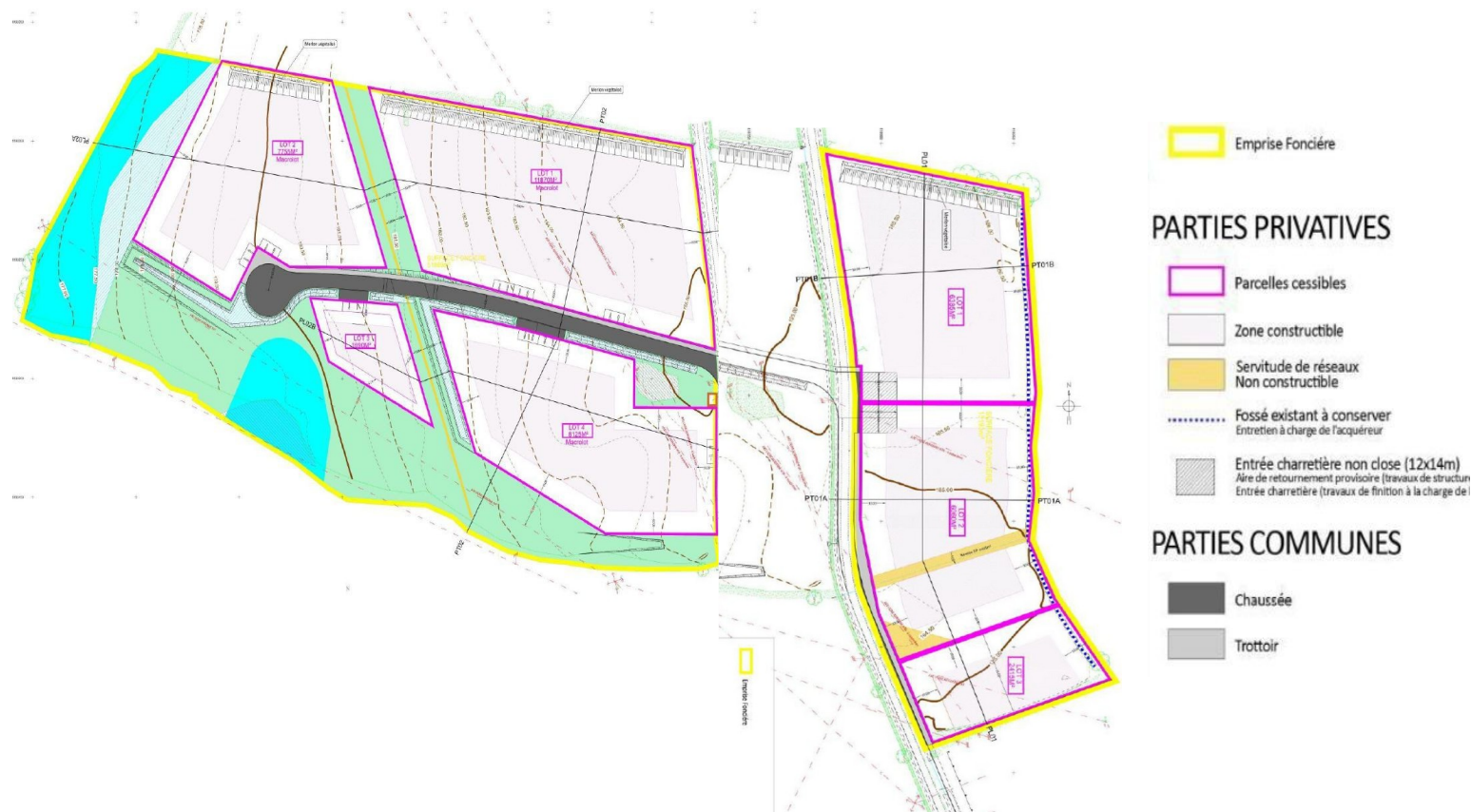
Plan schématique d'implantation du projet matérialisant les macro-lots et voiries des secteurs ouest et est – extrait de l'étude d'impact, pages 15 et 16.
