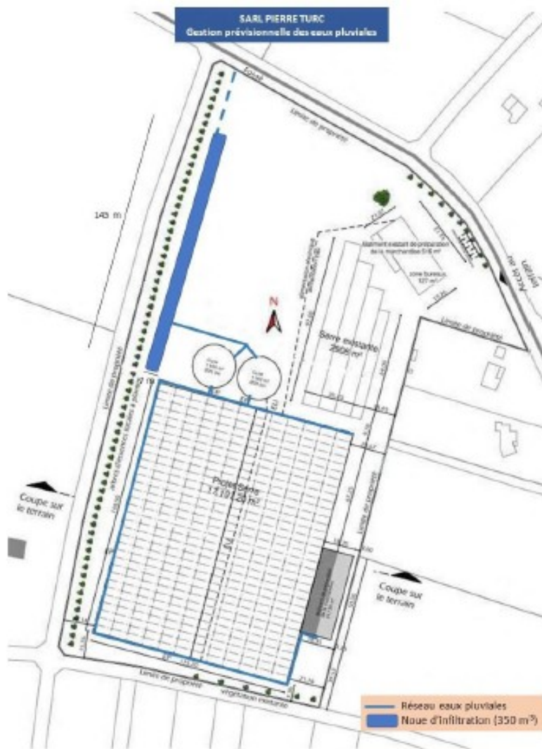
Implantation des nouvelles serres construites (source dossier)
