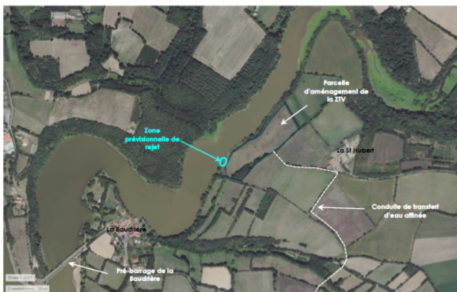
Localisation de l'arrivée de la canalisation de transfert, de la parcelle destinée à accueillir la ZTV et le point de rejet dans le Jaunay
