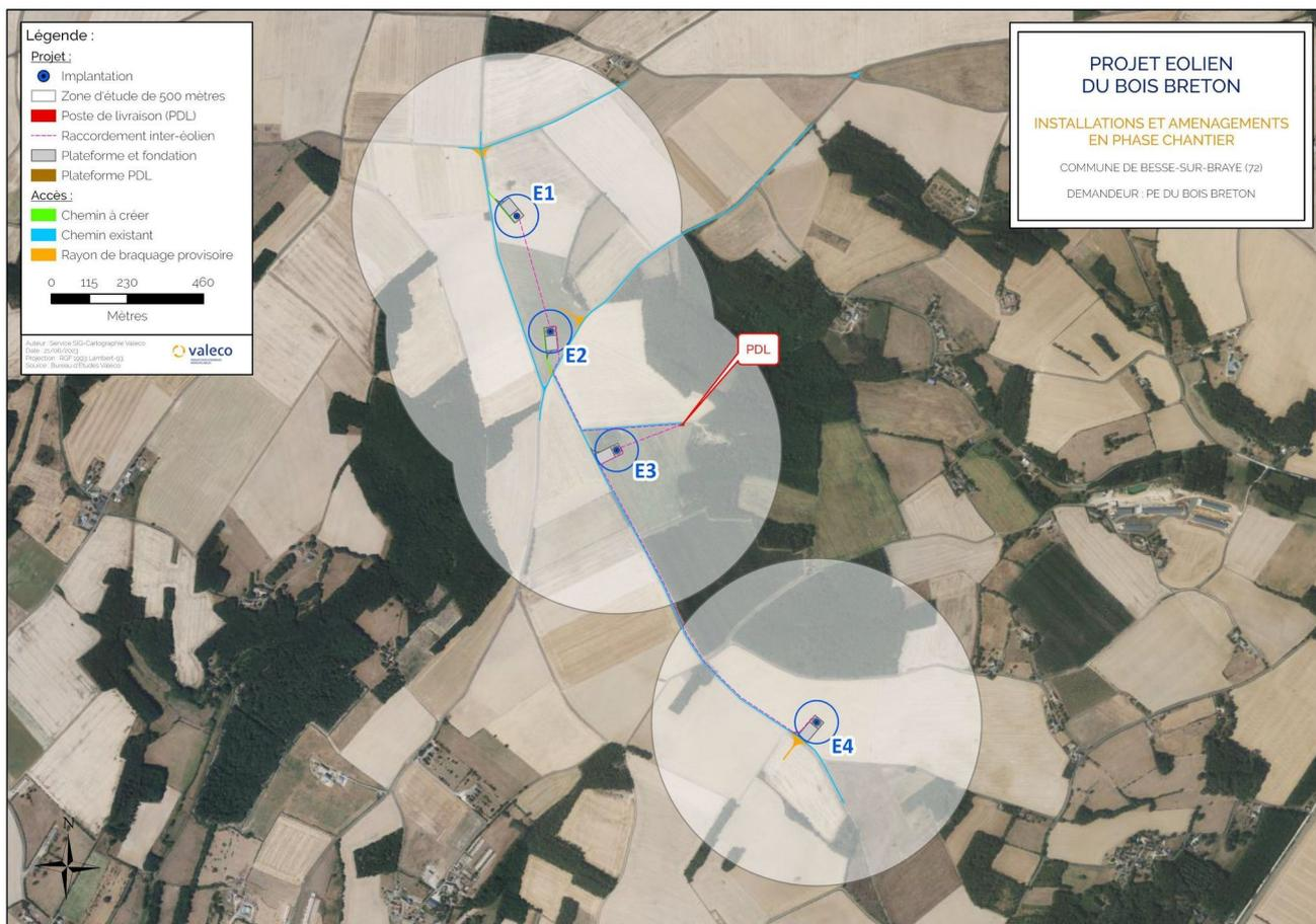
Figure 1: installations et aménagements en phase chantier (source : étude d'impact page 150)
