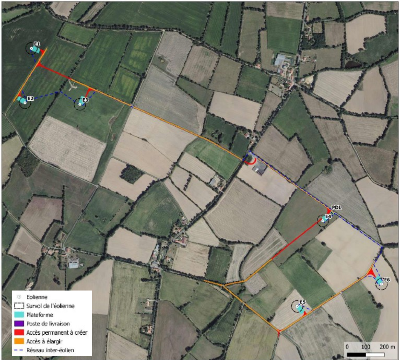
Représentation sur photographie aérienne des implantations d'éoliennes et des diverses infrastructures du projet
