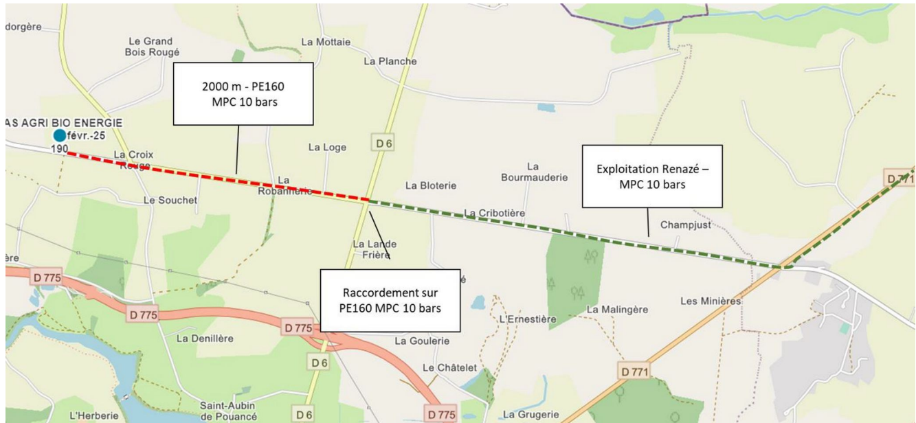
Tracé projeté de raccordement (Source : Étude de l'injection de biométhane dans le réseau de distribution de gaz naturel - GRDF)
