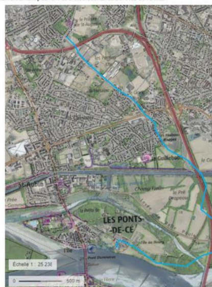
LA SOLUTION EST (A87 – Guillebotte – Remois) avec les grandes caractéristiques suivantes : - Linéaire total : 4 670 m - Linéaire sous espaces naturels : 1 810 m - Linéaire sous chaussée RD : 0 m - Linéaire sous chaussée VC : 2 430 m - Points particuliers : 430 m (4 forages souterrains + 2 ponts en encorbellement)
