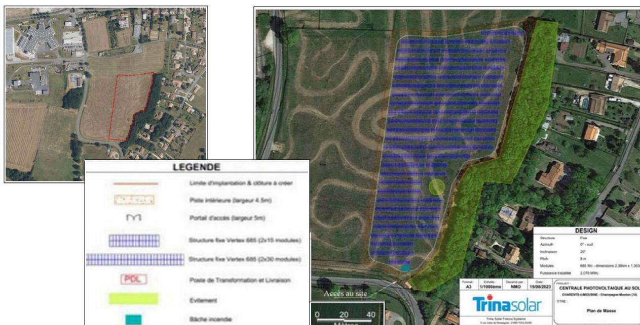
Localisation du terrain d'implantation du projet photovoltaïque (à gauche) et plan de masse (à droite)
