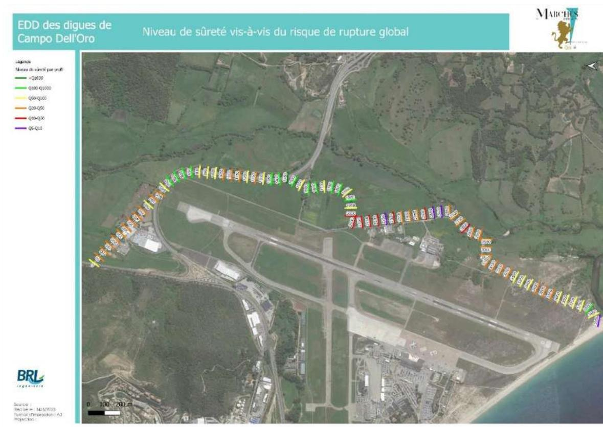
**Au vu de ces éléments, la DDT a donc choisi de retenir un scénario de défaillance simulant l'effacement des digues de la STEP et de l'aéroport.** Concernant la digue de la RT40, compte tenu de ses caractéristiques géométriques (et notamment de sa largeur), il a été décidé de ne pas l'effacer.
