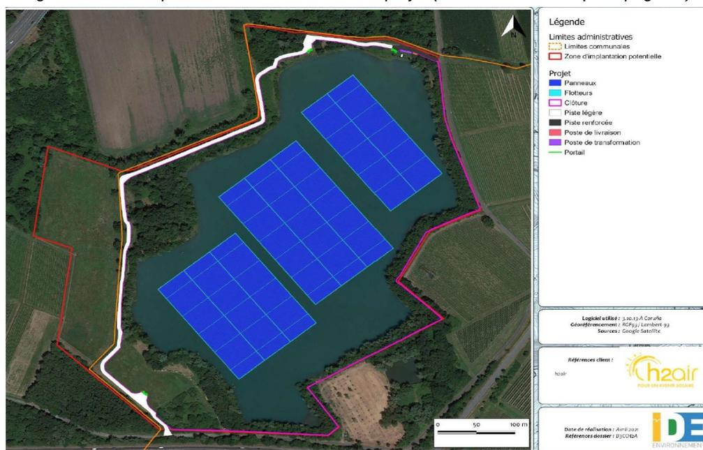
Figure 30 : Plan d'implantation du projet de centrale photovoltaïque flottante de Génissac
